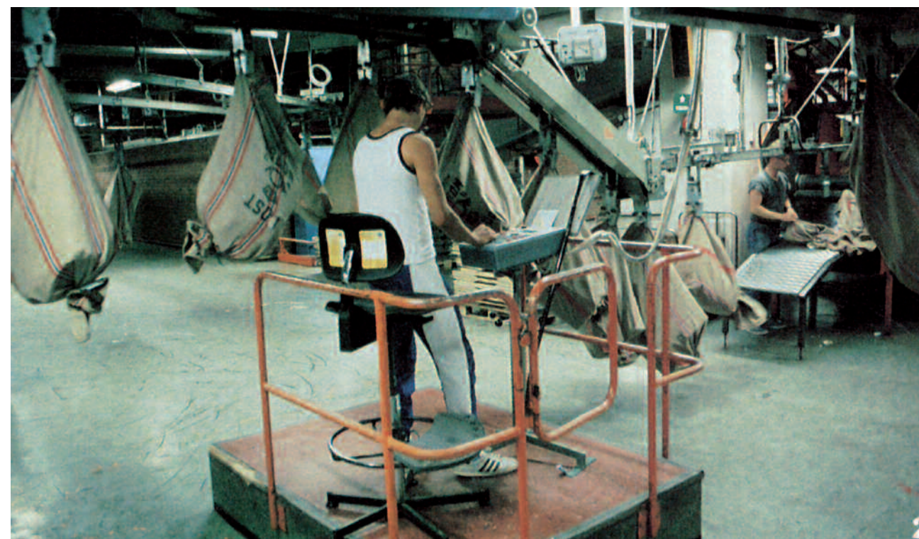
Sekkesorteringen i øvre kjeller var «hjerne» i transportsystemet. Postsekkene ble kodet til riktig bestemmelsessted. Foto: Posten
