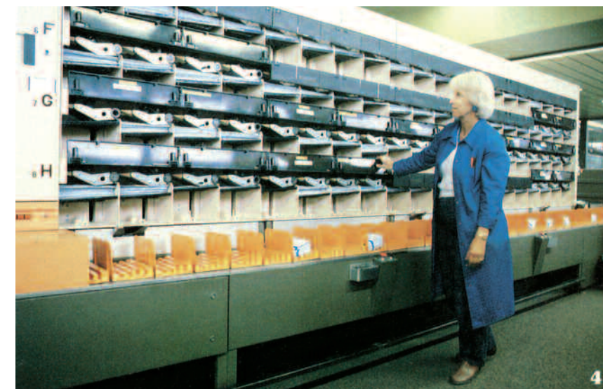
Brevsorteringsanlegget slik det sto i 4. etasje i 1980. Anlegget hadde ca. 180 uttak og kunne sortere ca. 20 000 brev i timen. Foto: Posten
