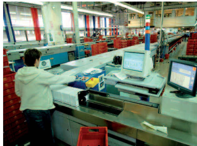
10. Grovsorteringsmaskin for små brev i 4. etasje.
