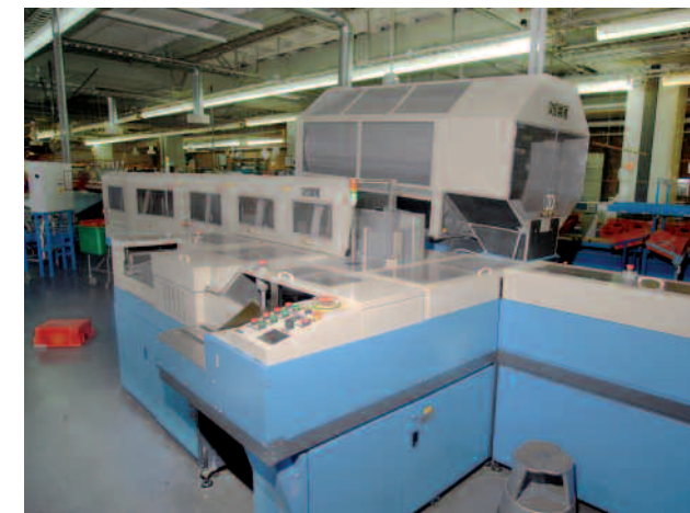
3. Maskin som tilrettelegger og stempler brev i 1. etasje.
