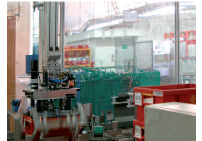
15. Anlegg med to lasteroboter for brevkassetter i 4. etasje.
