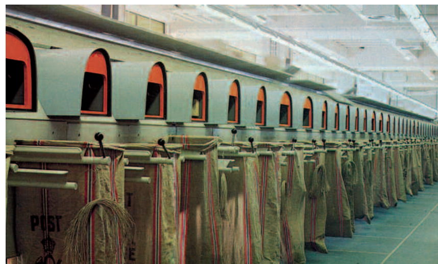
Norges første pakkesorteringmaskin ble installert i 2. etasje i Lavblokken og var 90 meter lang med 197 utkast og hadde 4 kodepult. Kapasiteten var ca. 5 000 pakker i timen. Foto:Posten
