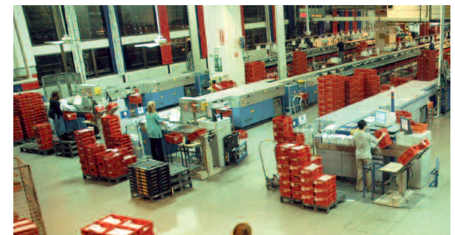
Bildet viser en del av maskinparken i 4.etasje. Det er i alt 13 maskiner for maskinell rute-klargjøring, 6 maskiner for grovsortering av små brev, 2 maskiner for sortering av store brev samt 1 maskin for finsortering av små brev.
